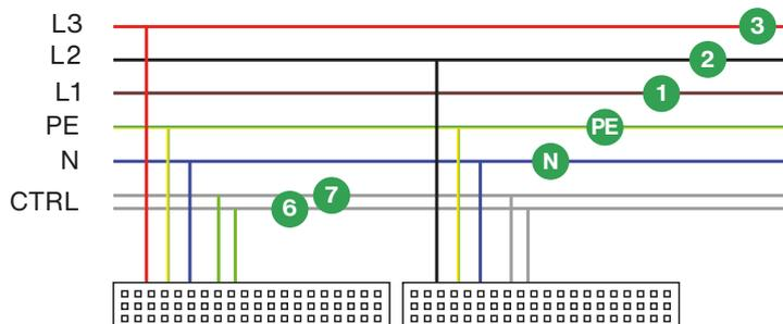
Im Beispiel sind zwei aufeinanderfolgende Kanalsegmente in der gleichen Linie verbunden und auch an den gleichen DALI-Bus angeschlossen.
